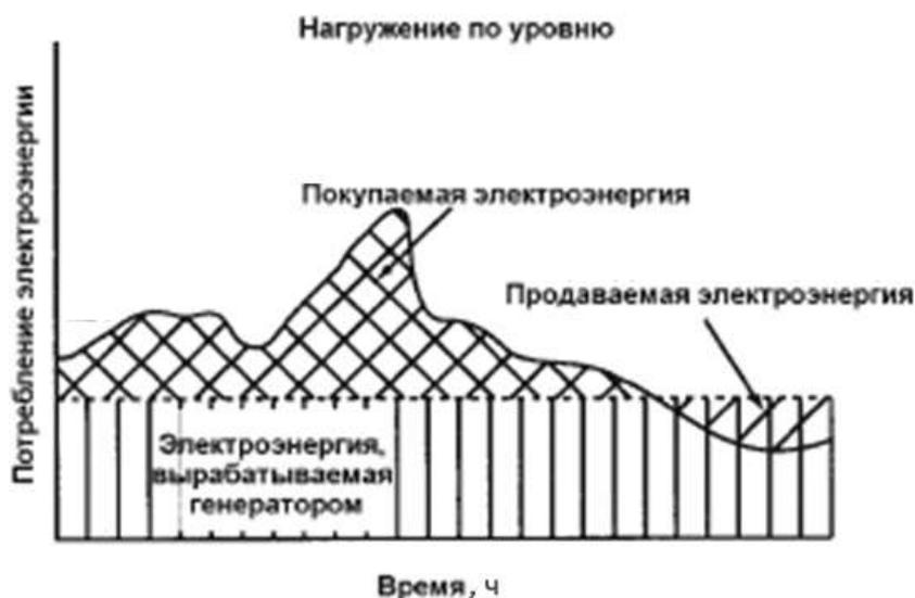
Рис. 3.2. Пример графика нагрузки предприятия с использованием блок-станций в режиме постоянной загрузки.
