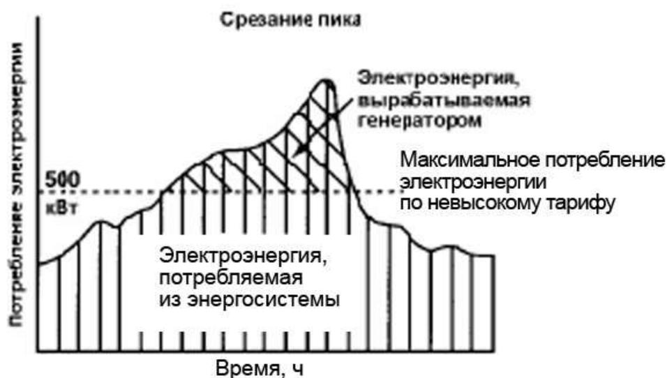
Рис. 3.1. Пример графика нагрузки предприятия с использованием блок-станций в режиме срезания пика.
